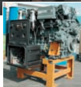
Ein Blockheizkraftwerk ist ein Kleinkraftwerk mit stationärem Motor (Bilder: SHL).
