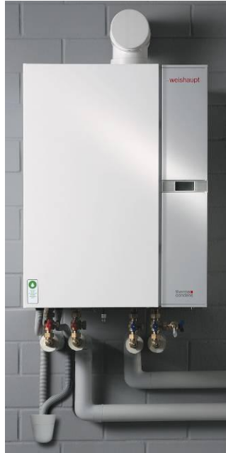
Bildlegende: Genau richtig für den sehr kleinen Heizraum: Das modulierende Öl-Wandgerät WTC-OW von Weishaupt. (H=80 cm, BxT=60 cm). Modulierende Leistung 5,5 bis 15 kW.
