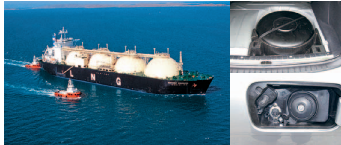
Réservoir à gaz de pétrole liquéfié (en haut) et orifice de remplissage (en bas) © autogas (2005)
